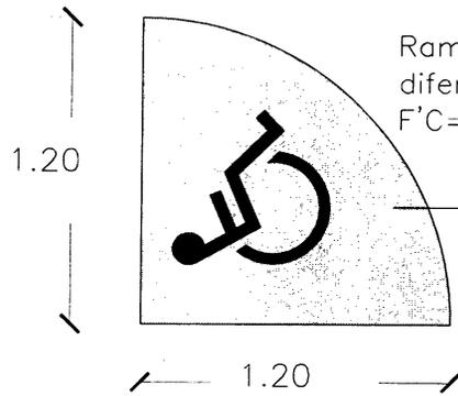
Rampa para personas con capacidades diferentes 10cm de espesor, concreto F'C= 150 kg/cm<sup>2</sup> agregado maximo de 3/4
